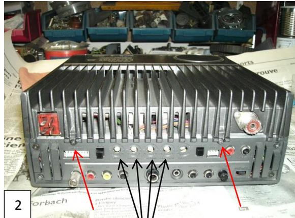
Retourner l'appareil et ôter les 8 vis du couvercle inférieur (flèches jaunes photos 1 et 3) et reposer l'appareil dans sa position normale.
